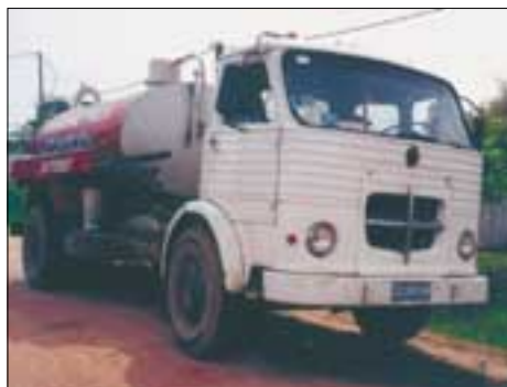
Este Pegaso 1090 Comet se carrozó como cisterna, con equipo de absorción de lodos. Realiza regularmente su servicio en Rincón de la Bolsa, una localidad sin saneamiento.
